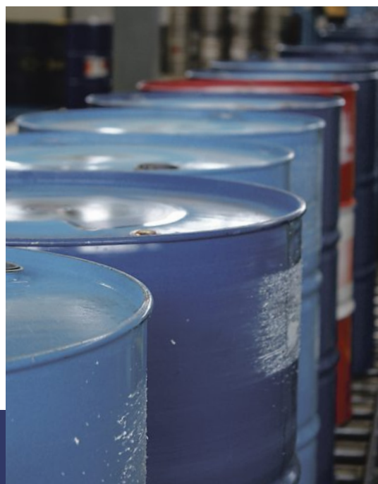
Viel zu gut, um es nur einmal zu verwenden: Ein 200-l-Stahlfass kann dank Rekonditionierung etwa vier- bis fünfmal wiederverwendet werden. Foto: Bayern-Fass
